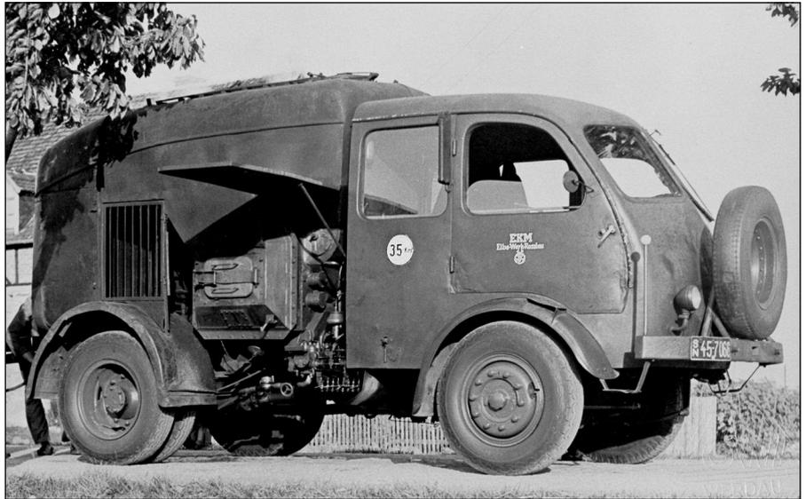
Sachsenberg-Dampfschlepper bei Versuchsfahrten durch die EKM
