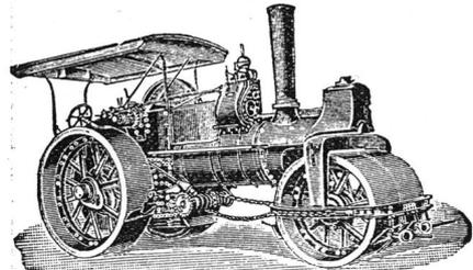
bewährter Konstruktion mit vereinfachten Compoundzylindern, fast geräuschlos und äusserst billig im Betrieb.
