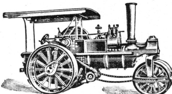
bewährter Konstruktion mit vereinfachten Compoundzylindern, fast geräuschlos und äusserst billig im Betrieb.
