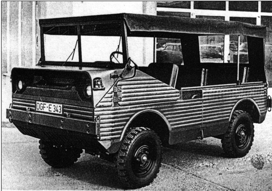
BMW-Glas-Lkw 0,5 t, ein schwimmfähiger Geländewagen-Prototyp für die Bundeswehr
