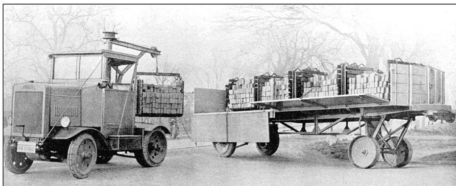
Die Fuchs-Zugmaschine ist mit einem sehr frühen Ladekran ausgestattet <sup>1</sup>
