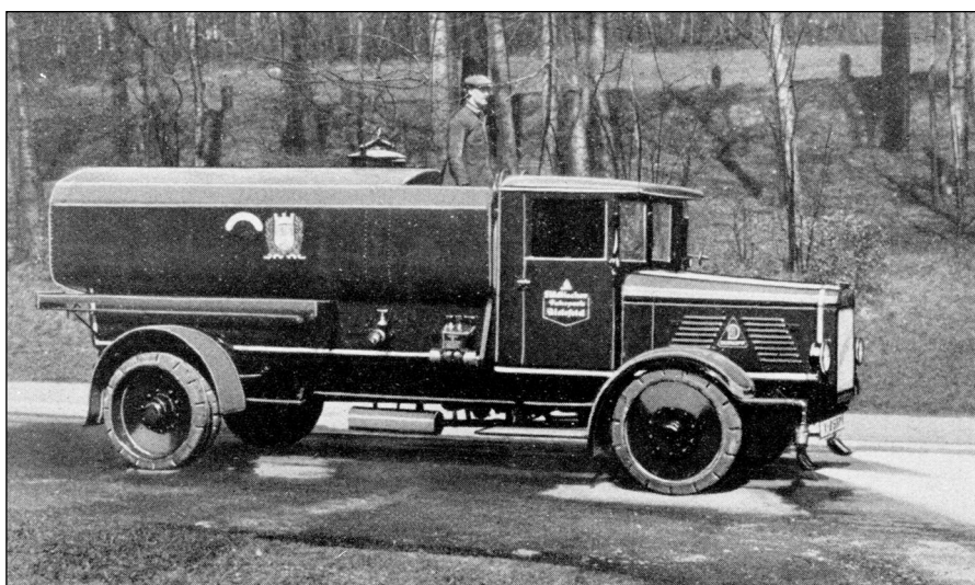
Der letzte Dürkopp-Schwer-Lkw Typ L 5 von 1928 als Sprengwagen ausgerüstet
