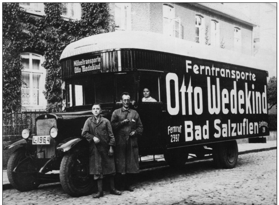
Dürkopp-Möbelwagen als Spezialanfertigung auf einem L 2,5-Fahrgestell 1926
