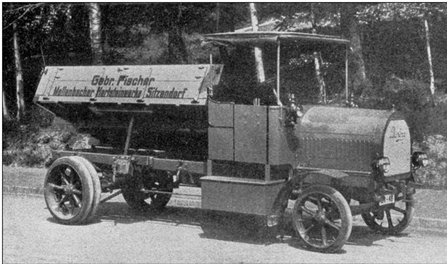
1914 Seitenkipper auf L 60-Fahrgestell für 3 Tonnen Nutzlast
