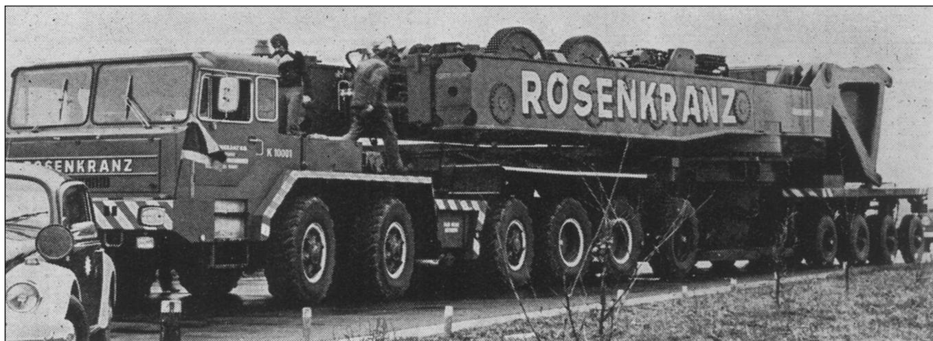
Bohne K 10 001 Gittermast-Autokran, 1000 t Tragkraft, 202 m Höhe von 1971
