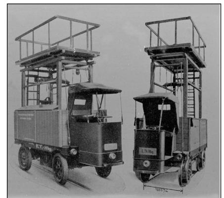
AEG-Turmwagen mit 1 Meter Spurweite
